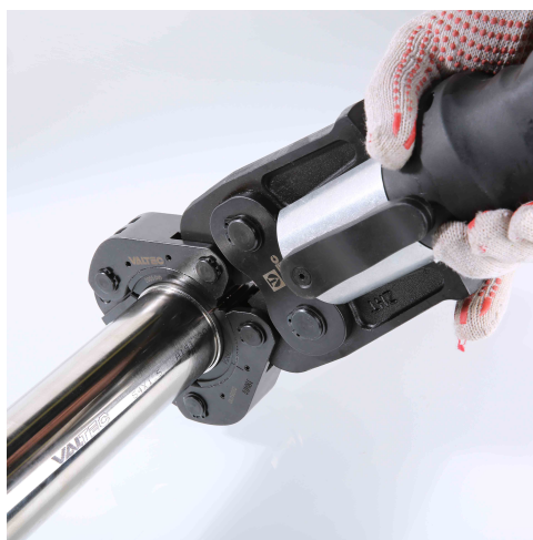
4. Опресовываем фитинг инструментом.
