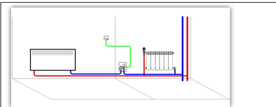
**VT.1СВОХ.5** Нагревательный прибор в высокотемпературной системе. Температура в помещении регулируется сервоприводом под управлением комнатного термостата.
