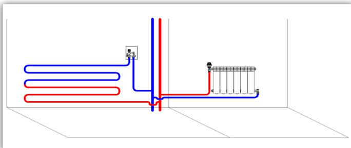
**VT.1СВОХ.2** «Теплая стена» в высокотемпературной системе. Температура в помещении регулируется термоголовкой (высота установки монтажного комплекта 1,5 м).
