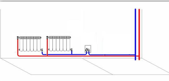
**VT.1СВОХ.4** Терморегулирование группой радиаторов в высокотемпературной системе отопления
