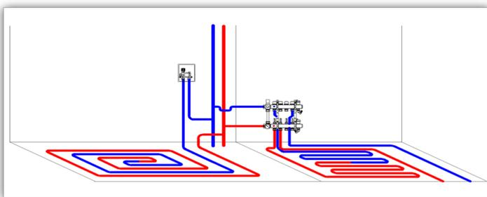
**VT.1СВОХ.2** «Теплый пол» в низкотемпературной системе. Температура в помещении регулируется термоголовкой (высота установки монтажного комплекта -1,2 м)..
