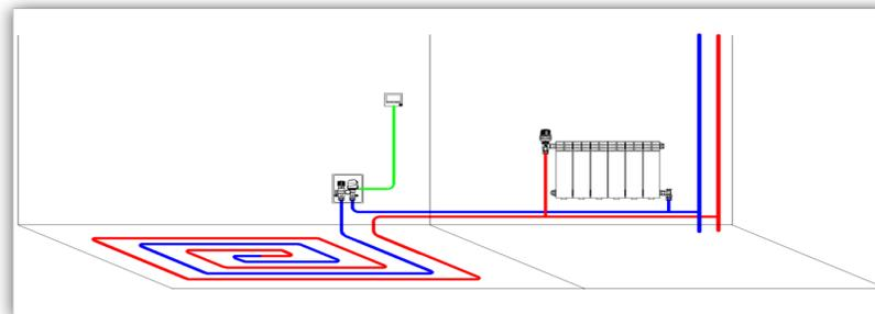
**VT.ICBOX.1** «Теплый пол» в высокотемпературной системе. Температура в помещении регулируется сервоприводом под управлением комнатного термостата.
