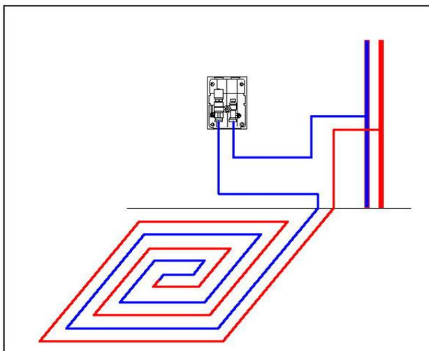
В этом случае, идет равномерное чередование «горячих» и «холодных» труб, что позволяет избежать наличия перегретых участков пола.
