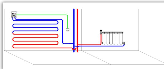
**VT.ICBOX.1** «Теплая стена» в высокотемпературной системе. Температура в помещении регулируется сервоприводом под управлением комнатного термостата.
