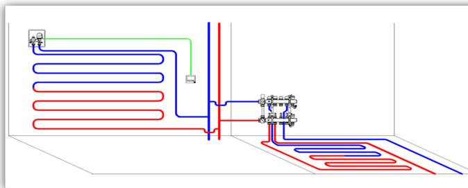
**VT.1СВОХ.5** «Теплая стена» в низкотемпературной системе. Температура в помещении регулируется сервоприводом под управлением комнатного термостата.
