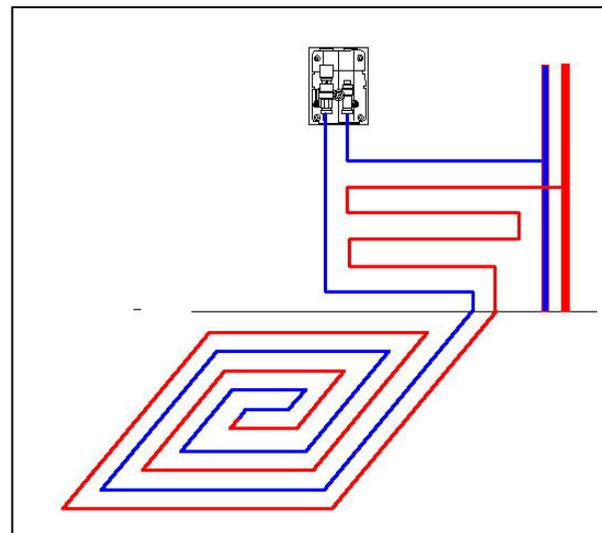
7.1.4. Чем больше будет задана толщина стяжки над трубой, тем равномернее будет температура поверхности пола. Не рекомендуется принимать толщину стяжки менее 50 мм над трубой.
