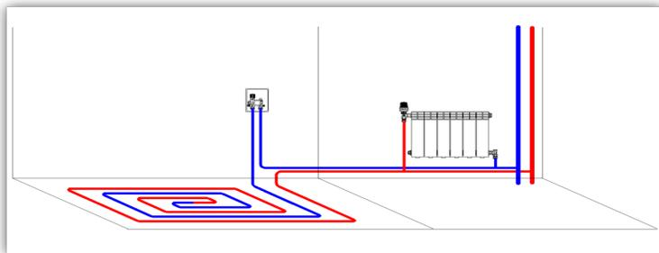
**VT.1СВОХ.2** «Теплый пол» в высокотемпературной системе. Температура в помещении регулируется термоголовкой (высота установки монтажного комплекта -1,2 м)..
