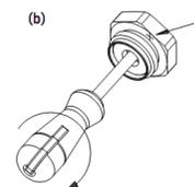
(c) - сделав отметку на отвертке для удобства отсчета оборотов, выверните винт-ограничитель на требуемое количество оборотов в соответствии с графиком (c);
