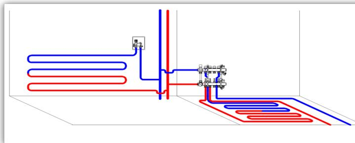
**VT.1СВОХ.2** «Теплая стена» в низкотемпературной системе. Температура в помещении регулируется термоголовкой (высота установки монтажного комплекта 1,5 м).
