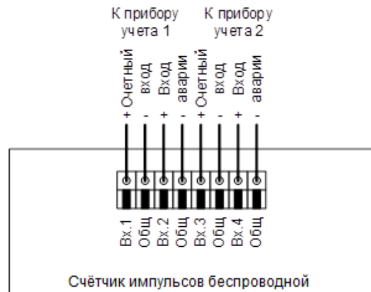
Рис.1 Пример подключения двух приборов учёта
