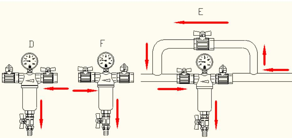
А) Перекрыть выходной кран. Открыть сливной кран и слить осадок в канализацию вместе с каким-то количеством сетевой воды. В этом случае частицы, оставшиеся на сетке, большей часть не удаляются из фильтра. Происходит удаление только шлама, осевшего на дне колбы (рис. D)
